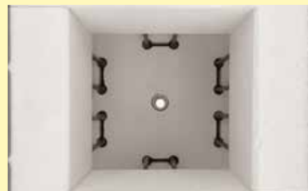
Sehr gute Temperaturgleichmäßigkeit durch Rund- beheizung des Ofenraums
