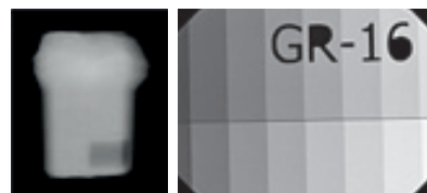
Abb. 24: Röntgensichtbarkeit printo ® dent GR-16 Xray im Vergleich zu einer Aluminiumtreppe (ISO 4049).
